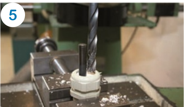
5 Podczas wykonywania drugiego otworu, pierwszy należy zamknąć wiertłem lub śrubą pasowaną, aby zapewnić stabilność wymiarową wkładki uszczelniającej.
