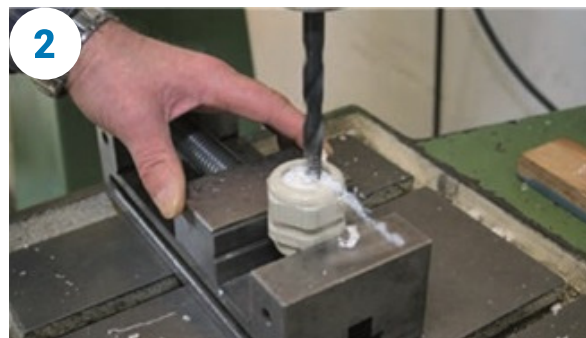
2 Ustaw wiertło w wybranym miejscu. Pracuj z niską prędkością za pomocą konwencjonalnej wiertarki HSS.
